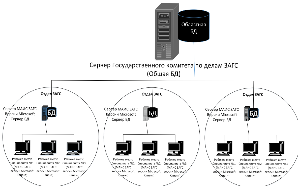
Рис. 2. Схема децентрализованной сети отделов ЗАГС при работе в программе МАИС ЗАГС версии Microsoft
