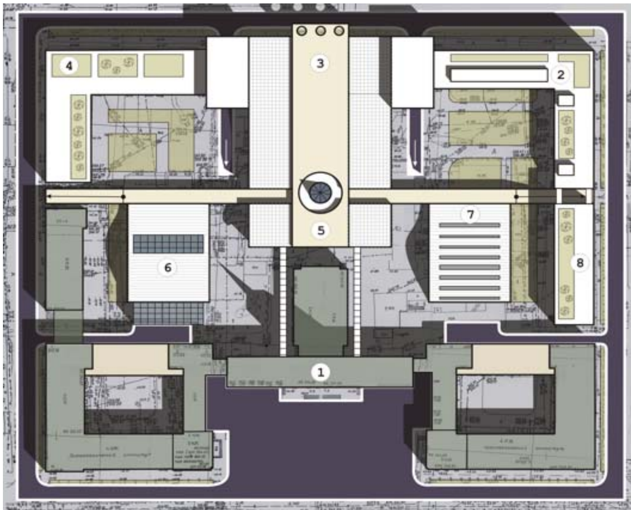
Рис. 4.12. Генплан технопарка университета: 1 – главный корпус; 2 – первый лабораторный корпус; 3 – корпус строительных машин; 4 – теплотехнический корпус; 5 – научно-исследовательский комплекс; 6 – здание РСУ; 7 – корпус военного факультет; 8 – новый учебно-лабораторный корпус
