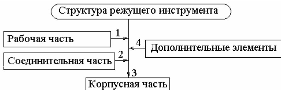
Рис. 2. Обобщенная структура функциональных частей режущих инструментов (РИ)
