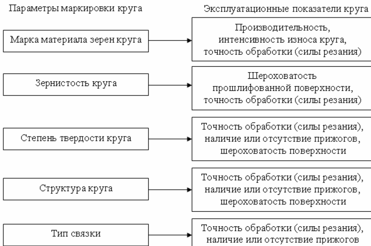
Рис. 1. Взаимосвязь параметров характеристики шлифовального круга с его эксплуатационными показателями
