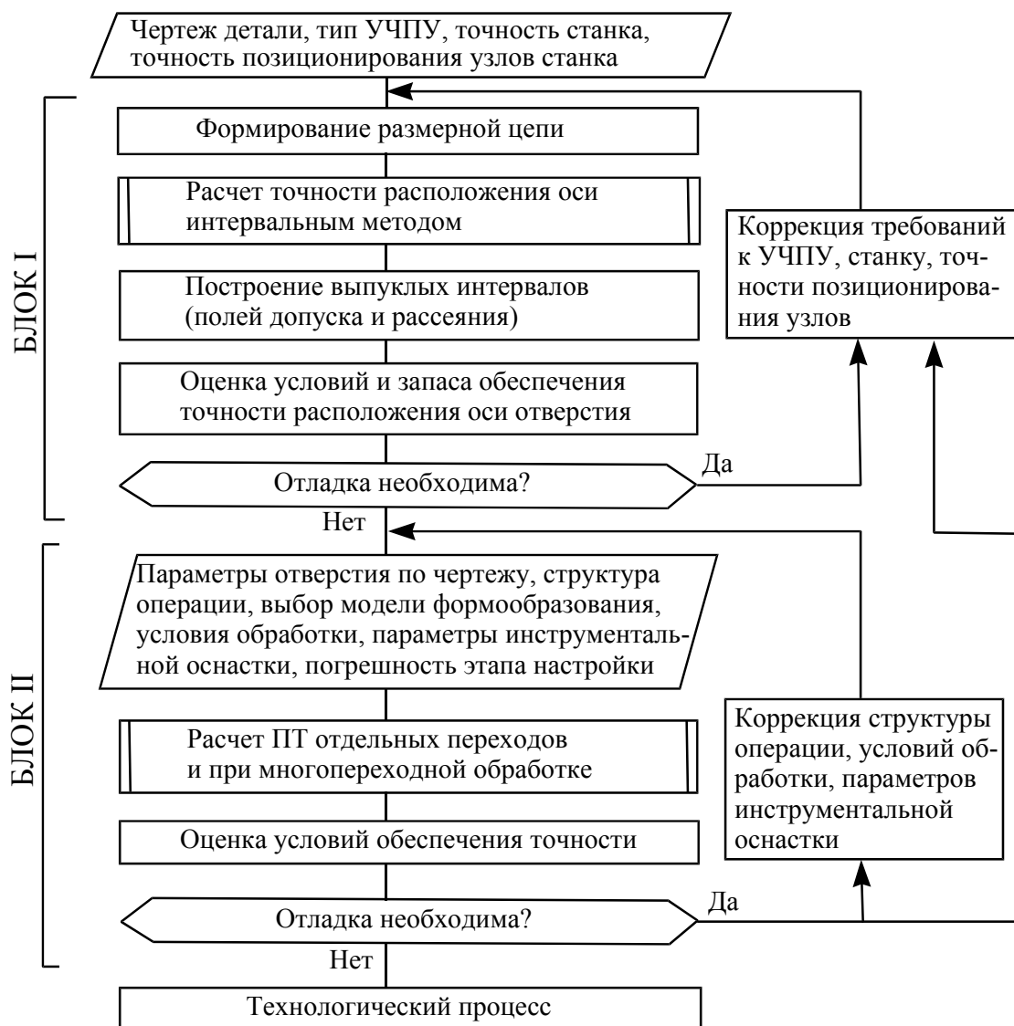
Рис. 1. Структура методики обеспечения точности отверстий концевыми мерными инструментами на станках с ЧПУ на стадии технологической подготовки производства: ПТ – параметры точности
