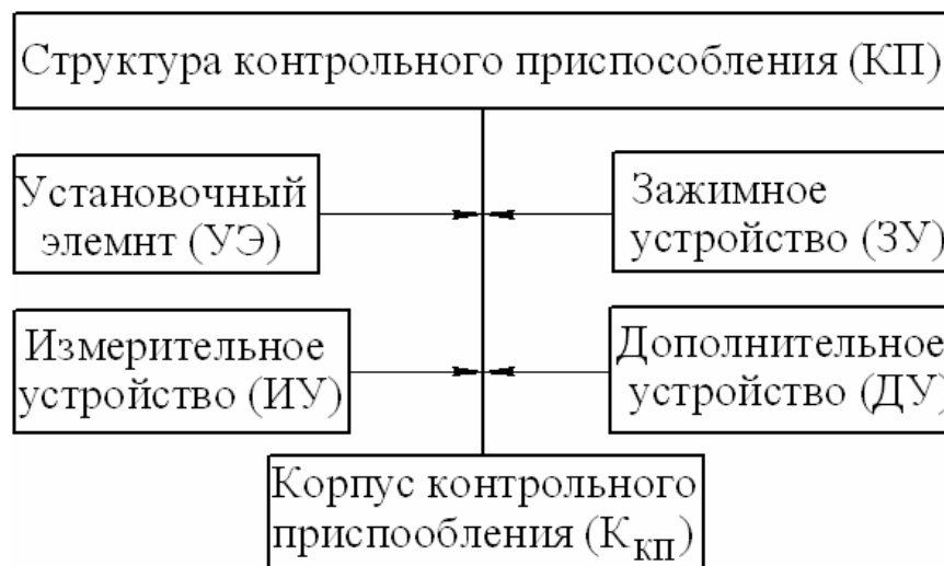
Рис. 7. Структура функциональных частей контрольного приспособления
