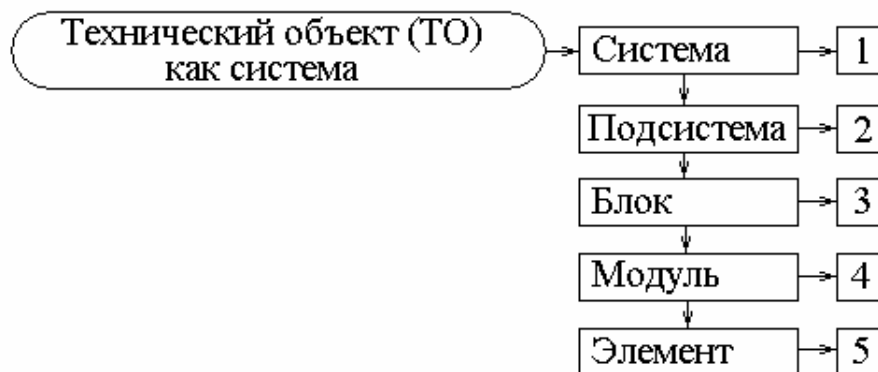
Рис. 3. Системная структура технического объекта (ТО)
