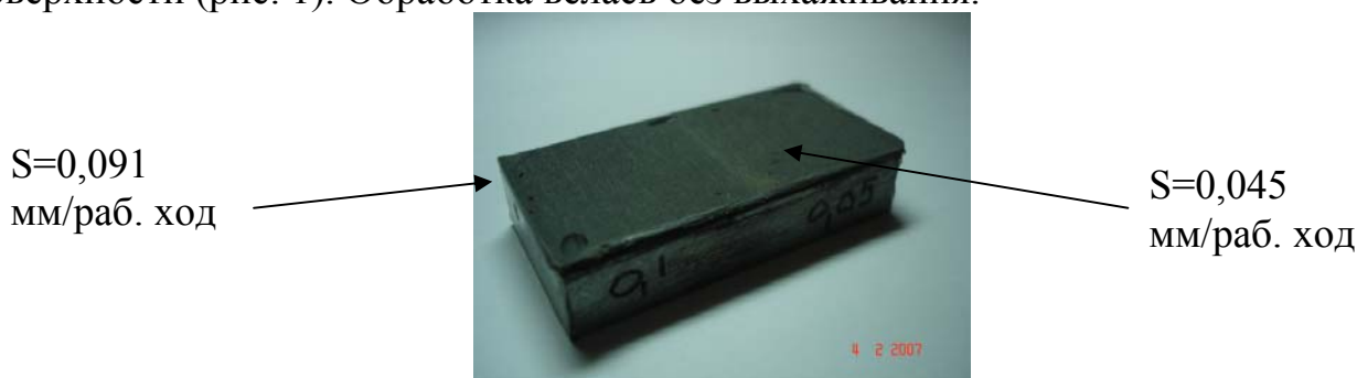
Рис. 1. Участки шлифованной поверхности с разными значениями радиальной подачи
