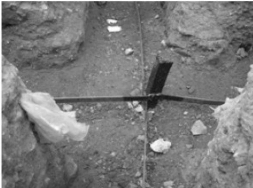
Рис. 2. Визуальный контроль состояния ЗУ на интенсивность коррозионного разрушения
