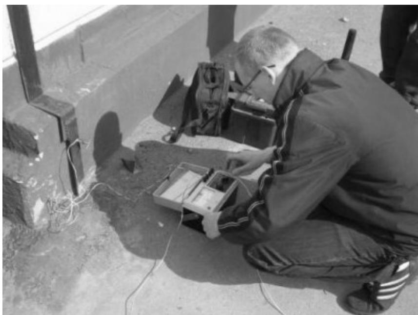
Рис. 1. Контроль сопротивления заземляющего устройства
