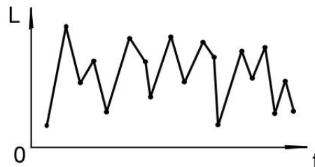
Рис. 1.17. Рассеяние размера, вызываемое случайной погрешностью обработки
