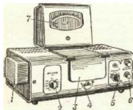
Рис. 3. Фотоколориметр КФК-2: 1 – осветитель; 2 – рукоятка смены светофильтров; 3 – крышка кюветного отделения; 4 – рукоятка перемещения кювет; 5 - рукоятка «Чувствительность»; 6 – рукоятка настройки прибора на 100 %-е пропускание; 7 – микроамперметр
