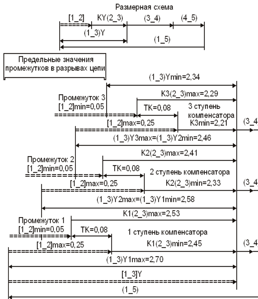
Рис. 5.37. Схема расположения полей допусков компенсаторов и промежутков
