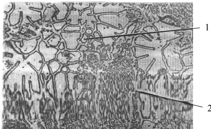
Рис. 5.6. Равноосные зерна в слитке алюминиевого сплава с 2 % Cu: 1 – додендритная зона; 2 – ячеисто-дендритная
