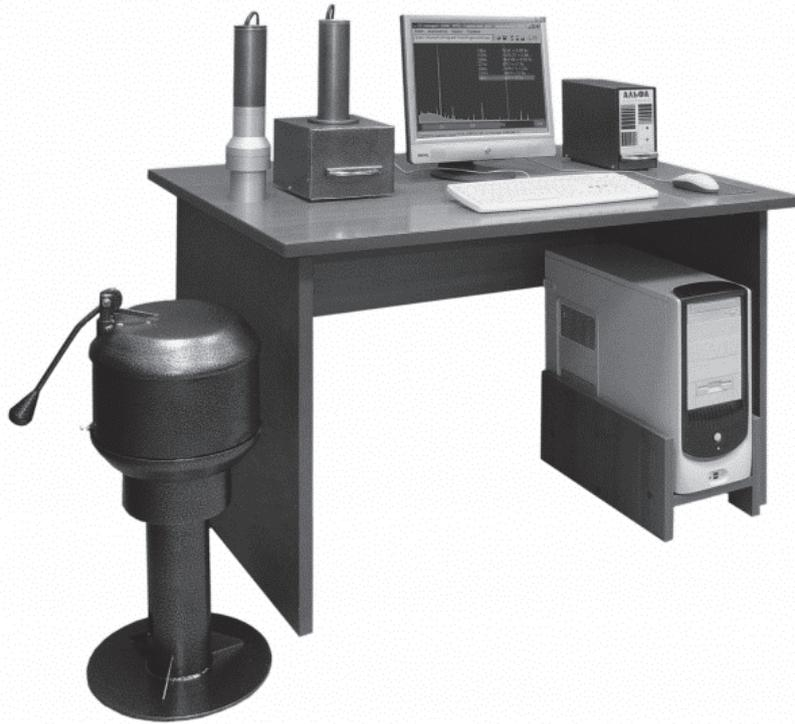
Рис. 3.11. ПРОГРЕСС-БГ+АР – Бета-гамма спектрометрический комплекс с альфа-радиометром
