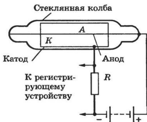
Рис. 2.1. Схема счетчика Гейгера-Мюллера
